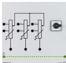
Trois résistances à réglage synchrone en 6 paliers, pour moteur à rotor bobiné et machine multifonction 0,3 kW.
