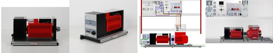
Le dynamomètre électrique est le système de base du système de test de machines pour l'enregistrement de la courbe des machines électriques de la catégorie 0,3•kW dans les quatre quadrants de fonctionnement. Ce système permet des essais selon la norme DIN/ISO 60034-2-1 «•Méthodes normalisées pour la détermination des pertes et du rendement à partir dessais (à l'exclusion des machines pour véhicules de traction), qui sont nécessaires pour les classes de rendement IE1 à IE4.
