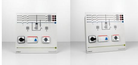
Pour connecter l'alimentation triphasée pendant des expériences avec des charges électriques alimentées par des tensions de ligne de 400 V.
