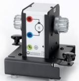
Sert à mesurer la vitesse de rotation des machines électriques des gammes 0,1 et 0,3 kW.
