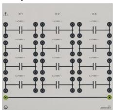
Trois batteries de condensateurs à papier métallisé comprenant chacune 4 condensateurs.
