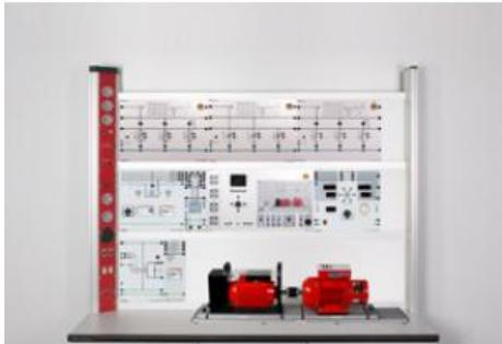
Les essais sont réalisés avec des machines de classe 1 kW fabriquées industriellement.
