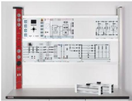
**E2.4.3.1 Electronique de puissance avec la commande de thyristors, transistors Mosfet et IGBT**
