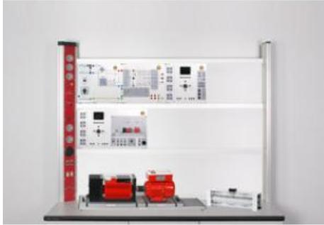
Ce stage de laboratoire fonctionne avec des plaques d'expérimentation dans un cadre profilé. L'alimentation électrique pour le convertisseur de fréquence est assurée par un inverseur directement à partir du réseau d'alimentation public (tension de réseau 230 V).
