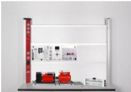
La partie électronique de puissance de ce stage de laboratoire travaille avec des plaques expérimentales. La machine électrique utilisée est une machine industrielle à socle dont les caractéristiques sont évaluées à l'aide du système de test de machines 0,3. L'alimentation électrique de la machine d'essai provient d'un convertisseur de fréquence industriel alimenté par le réseau public (tension de réseau, 230 V).
