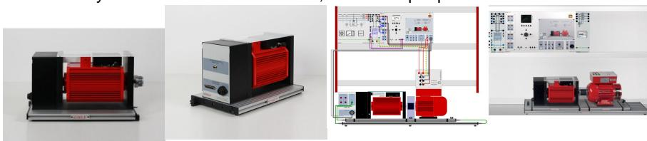
Le dynamomètre électrique est le système de base du système de test de machines pour l'enregistrement de la courbe des machines électriques de la catégorie 0,3kW dans les quatre quadrants de fonctionnement.
