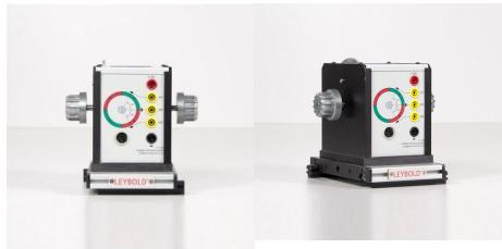
Pour détecter la position du rotor d'un moteur à courant continu sans balais et à aimants permanents (machine synchrone auto-pilotée).
