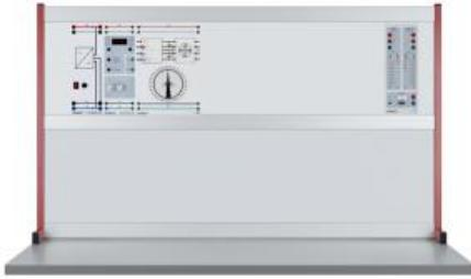
L'équipement permet l'analyse de la machine synchrone à excitation permanente à commutation sinusoïdale (PMSM) avec des aimants enterrés.
