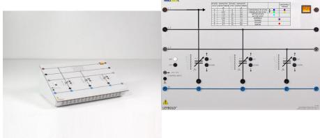
Charge capacitive triphasée, robuste et à usage universel, avec une puissance absorbée réglable jusqu'à 1 kvar. La capacité de chaque phase peut être modifiée individuellement en 15 pas, de 1,7  $\mu$ F à 26,3  $\mu$ F.
