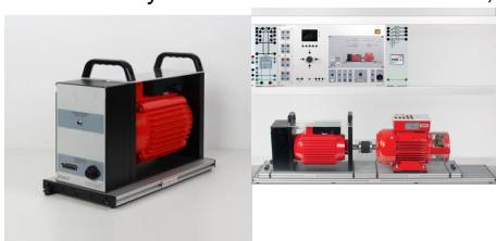
Le dynamomètre électrique est le système de base du système de test de machines pour l'enregistrement de la courbe des machines électriques de la catégorie 1.0 kW dans les quatre quadrants de fonctionnement.
