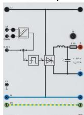
Alimentation réglable fournissant une tension et un courant lissés pour l'excitation d'un alternateur synchrone des gammes de puissance 0,3 kW ou 1,0 kW.
