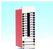
Inductance avec 20 points de prélèvement pour compensation des défauts à la terre du modèle de ligne 380 kV (bobine Peterson).
