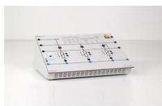
Charge ohmique triphasée, robuste et à usage universel, avec une puissance absorbée réglable jusqu'à 1 kW. La résistance de chaque phase peut être modifiée individuellement en 15 pas, de 2340 ohms à 155 ohms. Le pas et l'état de la charge sont affichés par des bandes lumineuses à LED de couleur sur la face avant.
