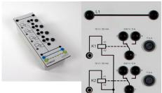
Extension pour une expérience supplémentaire avec le condensateur de démarrage contrôlé par la vitesse ou le courant par le système de la machine.
