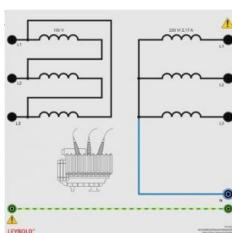
Le transformateur d'alimentation triphasé convertit une tension d'entrée de 150 V (tension entre les conducteurs extérieurs en triangle) en une tension de sortie de 230 V (tension entre les conducteurs en étoile).
