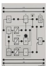
Cet appareil permet l'étude de différentes modulations d'amplitude (AM), par ex.:
