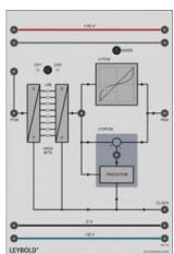
Le démodulateur PCM reçoit en série les données et le signal d'horloge transmis via une ligne de données commune (canal de transmission) par le modulateur PCM.
