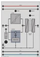
Dans le modulateur PCM (MIC), le signal échantillonné, à valeurs discrètes en temps, est quantifié et codé.
