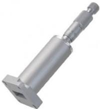
Ce composant constitue un court-circuit pour le mode TE10 du guide d'ondes rectangulaire, c.-à-d. qu'il produit un facteur de réflexion  $r = \text{env. } -1$ .
