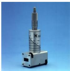
L'ondemètre est constitué par une cavité résonante cylindrique.
