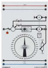
Potentiomètre à engrenage avec entraînement par moteur CC
