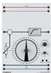
Transmetteur de position avec disque rotatif gradué en angle pour une utilisation dans des systèmes asservis. Avec n?ud additionneur d'entrée pour l'application de grandeurs perturbatrices ou la modification de la valeur de consigne et limiteur de croissance pouvant être mis en circuit avec des temps de montée de 1 V/s à 1000 V/s.
