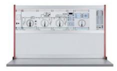
Les expériences sont réalisées avec des plaques expérimentaux dans un cadre profilé.
