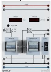
L'ensemble de machines 10 W est un système pour la commande et la régulation de la vitesse de rotation et de la tension.
