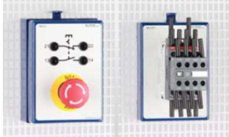
Expériences d'étudiant pour la commande des contacteurs avec des modules sur la grille de montage.
