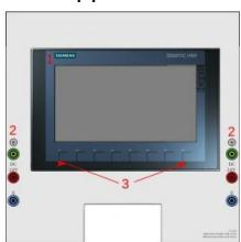
KTP700 BASIC, Basic Panel, écran tactile et touches tactiles, 7 » touch + key TFT Display 65536 couleurs, MPI, Profi-bus DP, PROFINET interface software WINCC BASIC V13/STEP 7 BASIC V13.
