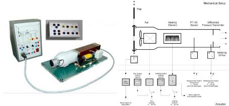
Le dispositif expérimental de laboratoire "Régulation de débit et de la température de l'air" comprends 2 systèmes (Premier ordre pour la régulation de débit, régulation de température d'un ordre supérieur).
