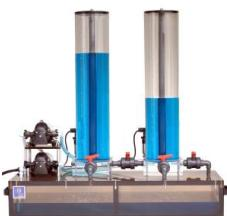
L'expérience de laboratoire "Système à 2 réservoirs DTS22" inclus la réalisation technique d'un système multivariable non linéaire (deux entrées deux Variables de sortie) avec deux actionneurs et un contrôleur numérique (Régulation non linéaire et découplage).
