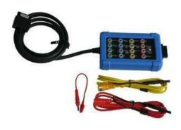
Le Boîtier de test CAN (CAN TEST BOX CTB) vous donne laccès facile aux 16 broches de la prise diagnostic de tout véhicule moderne - y compris les véhicules 24 volt.
