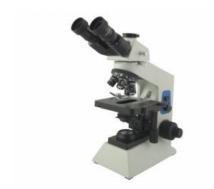
Le microscope BMS D1 a des objectifs de haute définition et un champ large (WF) oculaire avec optique plan.
