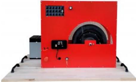
Maquette avec les éléments liés à la motorisation d'un cyclo électrique à moteur bruschless, pour la découverte d'une motorisation 100% électrique.
