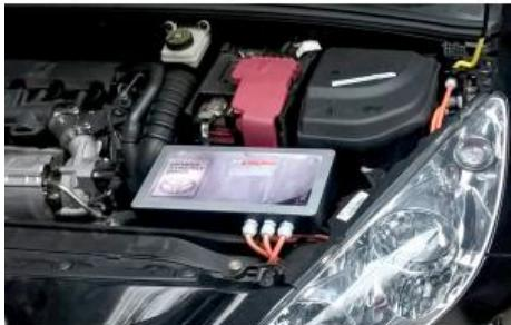
Boîtiers de simulation de véhicule électrique pour les formations à l'habilitation électrique B0L, B1VL, B2VL, BCL, conformément aux compétences du nouveau référentiel de formation de « maintenance des véhicules ».
