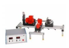
AT 200 est un dispositif d'essai complet composé d'une unité d'entraînement et d'une unité de freinage ainsi que de deux engrenages différents.
