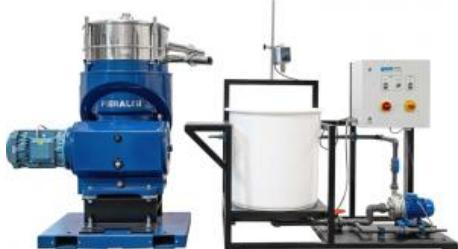
Une centrifugeuse à plateaux permet de séparer des mélanges de liquides non miscibles entre-eux. Lémulsion à séparer est préparée dans un réservoir de mélange.
