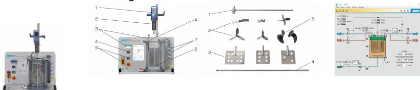
La fabrication de nombreux produits nécessite de mélanger des substances solides, liquides et gazeuses. Les exigences que doit remplir l'agitateur varient fortement en fonction des matériaux, c'est pourquoi il existe une grande variété d'agitateurs différents.
