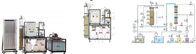
La filtration en profondeur à laide de filtres à sable et l'échange d'ions sont des opérations unitaires importantes du traitement de l'eau.
