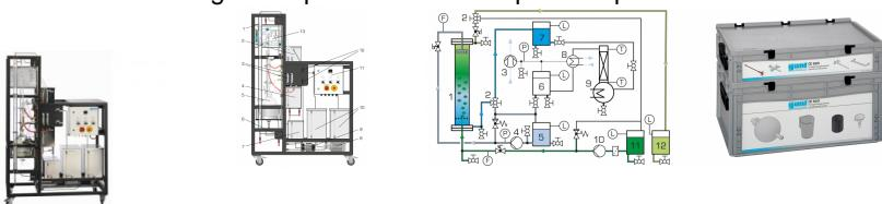
Le CE 620 permet de séparer les mélanges de liquides au moyen de l'extraction liquide-liquide.
