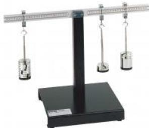
Le EM 049 permet d'étudier les principes de l'équilibre des moments en prenant l'exemple d'un levier à deux bras. Les moments créés au niveau du levier doivent être équilibrés.
