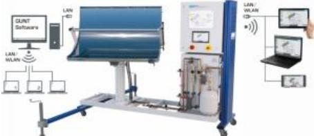
Les capteurs cylindro-paraboliques sont constitués de surfaces miroirs de forme parabolique dans lesquelles le rayonnement solaire est collecté et concentré dans un absorbeur.
