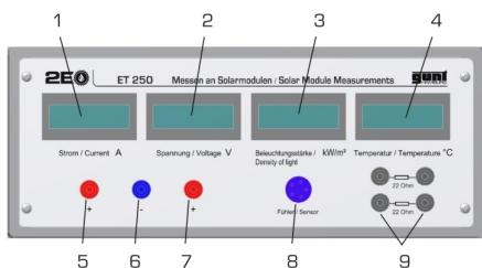
Affichages: 1 intensité électrique, 2 tension électrique, 3 éclairage, 4 température;
