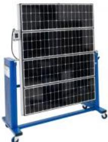
**Comportement en fonction des variations de température, d'éclairement avec solaire, lumineuse HL313.**
