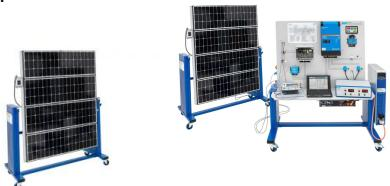
L'ET 255.02 est destiné à servir comme source d'énergie solaire pour le système d'énergie solaire ET 255 et comprend 4 modules photovoltaïques sur un bâti pivotant.
