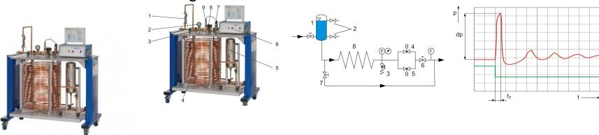
Les coups de bâlier dans les tuyauteries posent de sérieux problèmes à tout système technique, car ils peuvent causer des dommages importants sur les tuyauteries, les robinetteries et les composants d'une installation.
