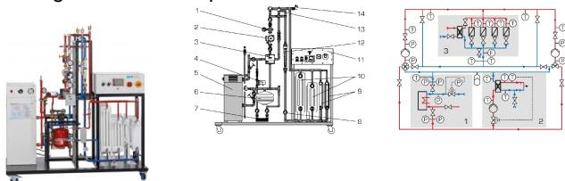
Le banc d'essai comprend deux circuits de chauffage autonomes équipés d'une vanne à trois voies et d'une vanne à quatre voies.
