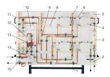
1 bâti, 2 raccords d'eau froide, 3 rotamètre, 4 échangeur de chaleur à plaques, 5 panneau, 6 vanne thermostatique, 7 purge d'air, 8 capteur de température du ocal, 9 thermomètre bimétalilique, 10 fégulateur de chauffage, 11 soupape de prop-plein, 12 capteur de température d'entrée circuit de chauffage, 13 pompe, 14 mélangeur, 15 raccords d'eau de chaudière
