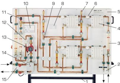
1 bâti, 2 raccords d'eau froide, 3 rotamètre, 4 échangeur de chaleur à plaques, 5 panneau, 6 vanne thermostatique, 7 purge d'air, 8 capteur de température du local, 9 thermomètre bimétallique, 10 régulateur de chauffage, 11 soupape de trop-plein, 12 capteur de température d'entrée circuit de chauffage, 13 pompe, 14 mélangeur, 15 raccords d'eau de chaudière
