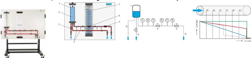
Les évolutions de la pression des fluides en écoulement ou au repos dans des conduites sont fondamentalement différentes l'une de l'autre.
