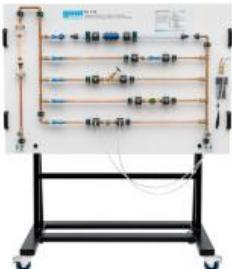
Des pertes de charge se produisent dans les systèmes de tuyauterie suite au frottement et aux turbulences. Dans la pratique, des pertes de charge ont lieu suite à l'utilisation de robinetteries d'arrêt dont il faut donc tenir compte lors du dimensionnement des réseaux de tuyauteries.
