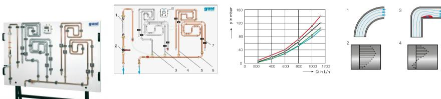
Dans les tuyaux traversés par un écoulement, en plus des pertes de charge suite au frottement du tuyau, on observe également des pertes de charge au niveau des changements de direction de tuyau.
