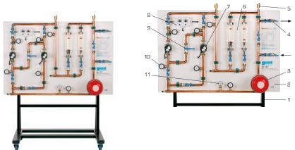
Le banc d'essai comprend un système de tuyauterie avec deux pompes de circulation.
