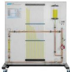
Lors de l'écoulement d'eau au travers d'un système de tuyauterie, des résistances apparaissent sous l'effet de changements de direction, de robinetteries et du frottement du tuyau.
