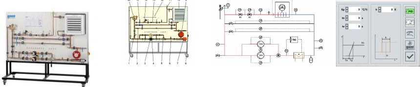
Le banc d'essai contient un cycle complet et fermé avec pompe de circulation, dispositif de chauffage électrique, convecteur pour émission de chaleur, différentes sections de tuyau, armatures et éléments de sécurité.
