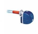
On distingue deux types de brûleurs à fioul: les brûleurs à flamme jaune et les brûleurs à flamme bleue. Dans le cas des brûleurs à flamme jaune, le fioul est uniquement pulvérisé avant la combustion, tandis que sur les brûleurs à flamme bleue, le fioul est vaporisé et une partie des gaz déchappement chauds est reconduite à la racine de la flamme du brûleur.
