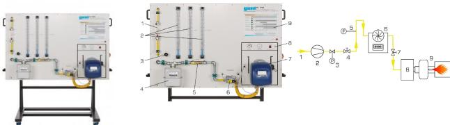
Le banc d'essai contient un brûleur à gaz à air soufflé du commerce.
