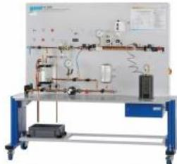
Le banc dessai permet détudier et dévaluer divers dispositifs de sécurité et appareils de contrôle.
