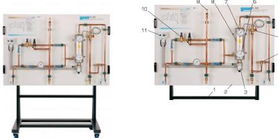
Sur le banc d'essai se trouve un réservoir sous pression chauffé électriquement.
