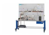
Le banc dessai permet détudier et dévaluer divers dispositifs de sécurité et appareils de contrôle. Tous les composants utilisés sont des composants industriels usuels. Les valeurs mesurées sont transmises vers un PC afin dy être évaluées à laide dun logiciel fourni. La transmission des données au PC se fait par une interface USB.
