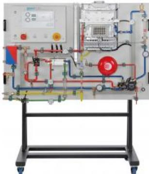
**HL 530 Chaudière murale 18 kW à double fonction (chauffage/eau chaude) à gaz (065.53000)**
