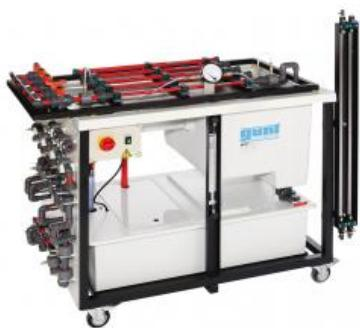
L'une des tâches importantes de la construction de conduites consiste à déterminer la pression et le débit dans des systèmes de conduites complexes.
