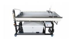
Avec HM 144, des phénomènes importants du transport par charriage dans la zone proche du lit sont montrés avec un écoulement sous-critique.
